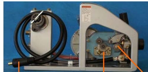
Manguera de gas de 4.5m, cable de control, cable de control remoto, y cable de soldadura positivo con conector Dinse
